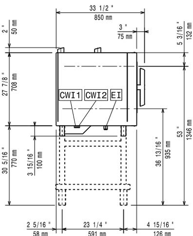
CWI1 = Kaltwasserzulauf      EI = Elektroanschluss
